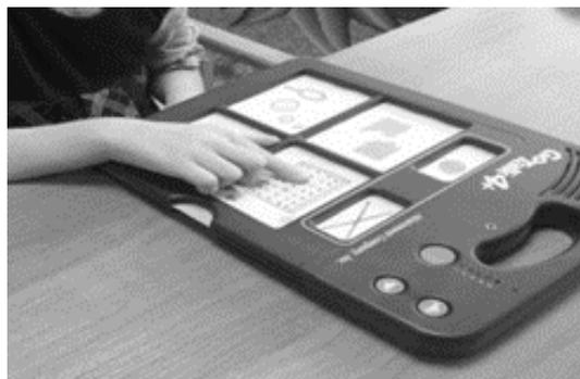
Панель для сменных таблиц со зрительными образами и встроенный микрофон, в память которого заносится речевое сопровождение изображений. Устройство записывает и воспроизводит 4 10-секундных сообщения. В рамку коммуникатора помещается карточка с изображением предметов или действий, и к ней привязывается голосовое сообщение, которое записывается самостоятельно через GoTalk.
